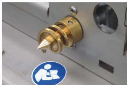
Zaryglowanie pokrywy – mechanizm odporny na zamarzanie i zanieczyszczenia
